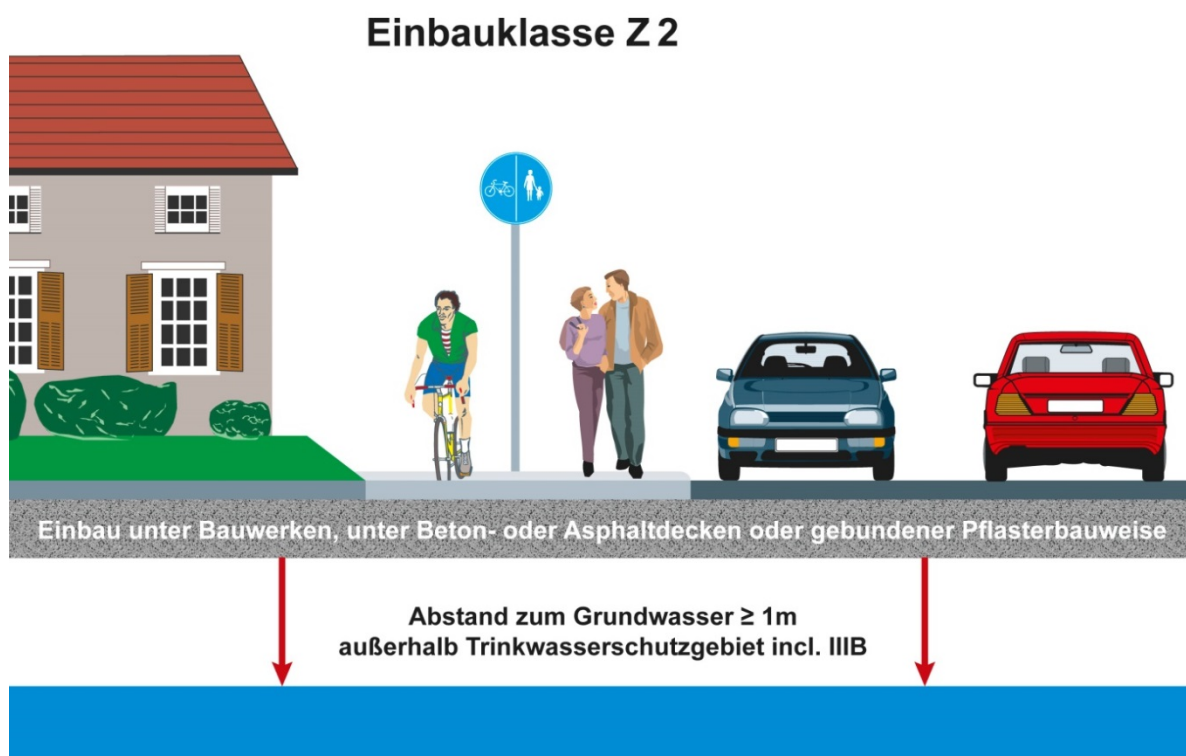
Abb. 1: Schematische Darstellung der Einbauklasse Z2 mit exemplarischer Angabe der Randbedingungen (Grafik: Ifeu-Institut)
