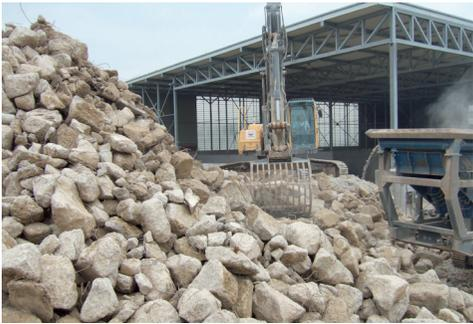
Mineralische Bauabfälle können in geeigneten Recyclinganlagen zu hochwertigen Baustoffen aufbereitet werden. Um gewährleisten zu können, dass die für ihren jeweiligen Einsatz erforderlichen Qualitäten und Produktanforderungen sicher eingehalten werden, ist die Herstellung dieser Baustoffe mit einer umfangreichen Qualitätskontrolle und Gütesicherung verbunden.
